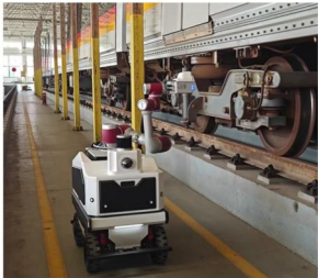
地铁巡检机器人
