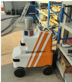
电力巡检机器人
