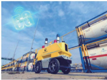
港口巡检机器人
